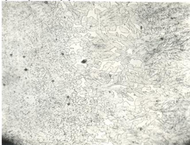
Рис. 2. Микроструктура сварного шва образца стали ЭК-181 ( \times 100 )
