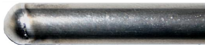
Рис. 12. Сварное соединение стали ЭК-181, выполненное дугой, управляемой магнитным полем (ДУМП)
